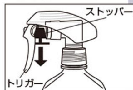
スプレーポンプのストッパーを矢印の方向に引き抜いて使用してください。使用後は、誤まって液が噴出しないようストッパーをして保管してください。
